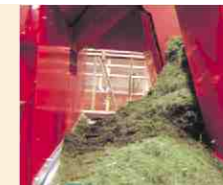
Das breite Querförderband sorgt für eine schnelle Verteilung ohne Verlust durch Herunterfallen.
