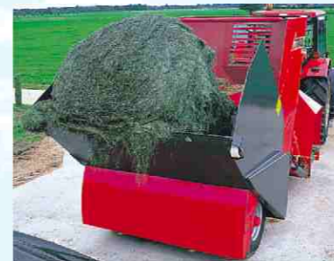
Loses Material, große Siloblöcke und Rundballen können ohne Verlust aufgeladen werden. Das Sichtfenster an der Vorderseite und die niedrige Einkipphöhe ermöglichen eine optimale Sicht beim Laden.
