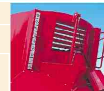
Eine Sichtöffnung für die Mischkammer und das Querförderband gehören zur Grundausstattung. Eine Anzeige mit Skaleneinteilung gibt die Stellung der Verteilklappe an.
