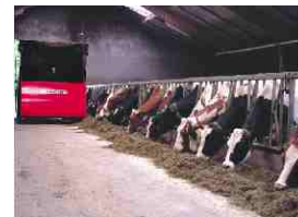
Schnelle und gleichmäßige Verteilung. Die Anordnung der Reifen und die Geschwindigkeit des Querförderbands sorgen dafür, daß beim Verteilen nicht über das Futter gefahren werden kann.
