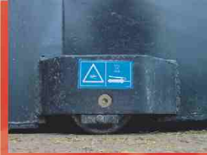
Spezielle Laufräder unter der Ladeklappe vereinfachen die Aufnahme des Silofutters.
