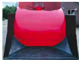
Solide konstruierte Ladeklappe mit breitem Verschleißstreifen und hohen Seitenwänden. Die Rundungen in den Ecken zentrieren den Block bei der Aufnahme.
