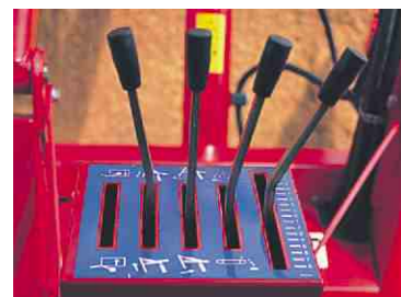
Alle Funktionen sind über Handventile einfach vom Fahrersitz aus zu bedienen.
