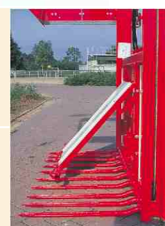
Die Haltezinken halten nicht nur die Silage gut fest, sondern schützen gleichzeitig die Schneidmesser vor Steinen usw., weil sie etwas länger als die Messer sind.
