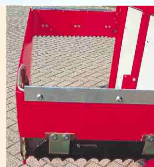
Der Schneidrahmen ist sehr schlank konstruiert, sodaß ein minimaler Schnittwiderstand entsteht.
