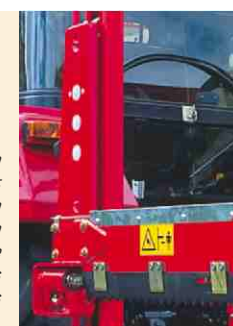
Die elektro-hydraulischen Ventile mit Gehäuse lassen sich einfach und schnell montieren.
