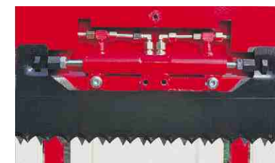
Extra Schneidkraft durch zwei separat angetriebene und vernünftig integrierte Sägezylinder.
