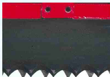
Die Haltezinken halten nicht nur die Silage gut fest, sondern schützen gleichzeitig die Schneidmesser vor Steinen usw., weil sie etwas länger als die Messer sind.
