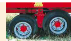
Typ Triomix S2 ist serienmäßig ausgerüstet mit einer Tandependelachse.
