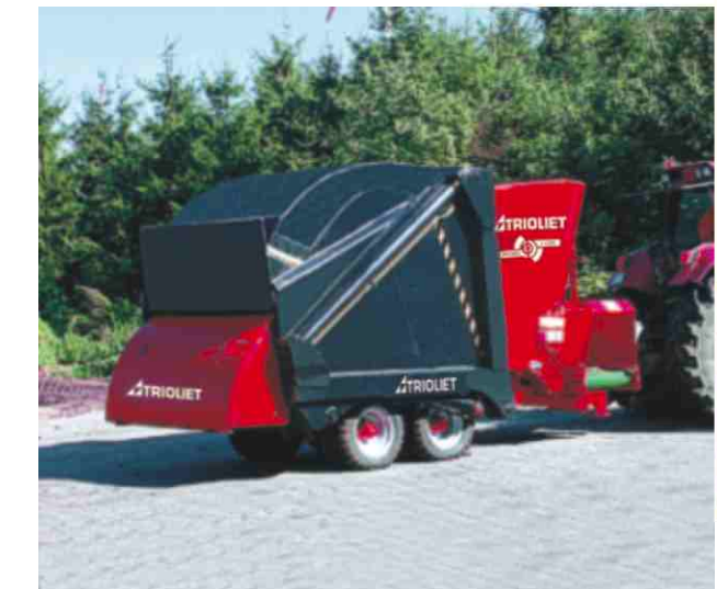
Eine gut sichtbare Kontrollleuchte an der Vorderseite des Triomix zeigt dem Fahrer wann das Schneidschild bis auf die Ladeklappe runtergeschnitten hat.
