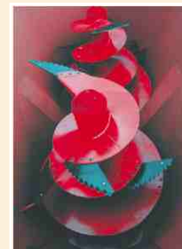
Die zwei planetair angetriebenen Vertikalschnecken mit Messern gewährleisten eine lockere und wenig Leistungsaufwand erfordernde Mischung.
