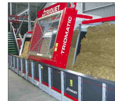
Quer- und Schrägförderband mit elektronischer Waage
