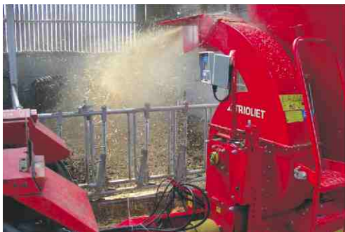
Wurfweite Strohgebläse: 15 bis 18 m.
