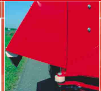
Der Silobuster/Silokamm ist serienmäßig ausgerüstet mit total abgeschlossenen Verteilklappe(n) und Seitenschutzrolle(n).
