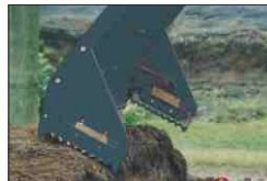
Das Schneidsystem des Silobusters ist sehr beständig gegen Gäräfte.
