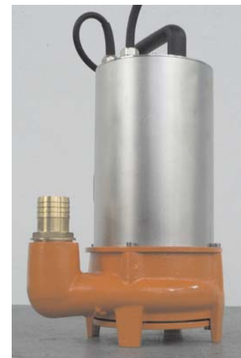
Pumpe PTS 40 (Bild oben) - Für 230 oder 400 V lieferbar - Mit oder ohne Niveauschalter - Leistung 0,75 oder 1,1 kW - Fördermenge 360 oder 420 l/min - Förderhöhe bis 13 bzw. 17 Meter
