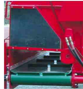
Das breite hydraulisch angetriebene Querförderband hat eine Dosierhöhe von 0.60 m.
