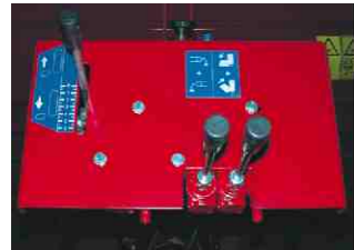
Alle Funktionen lassen sich hydraulisch von der Schlepperkabine aus bedienen. Deutliche Symbole geben die Funktion jedes Hebels an.
