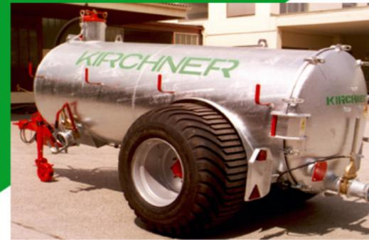
**Vakuümfässer** werden mit leistungsstarken und zuverlässigen **Kompressoren** ausgerüstet.
